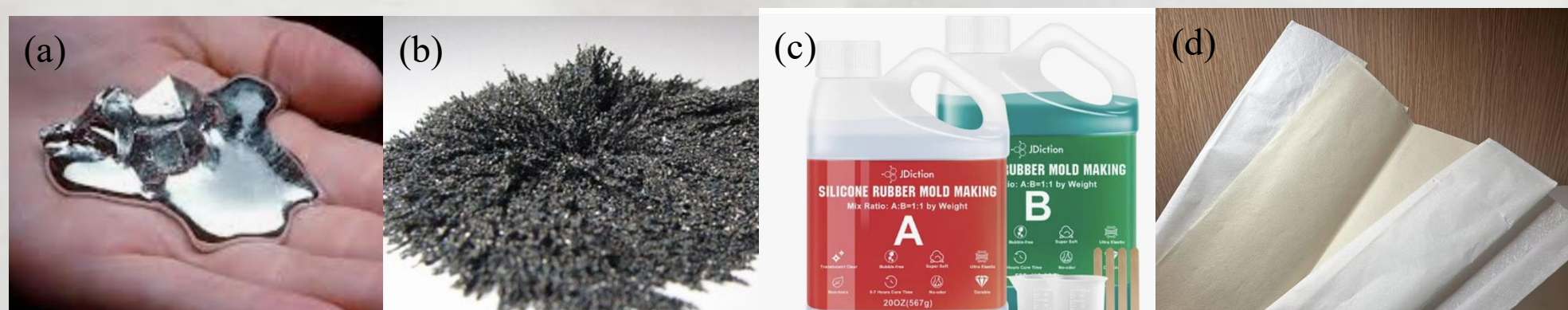
Figure.3 Materials: (a) liquid-metal ,(b)NdFeB powders, (c) silica gel, (d) paper
